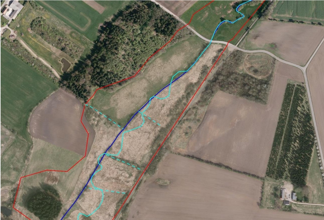
Figur 14 Oversigt over grøfter til omlægning
