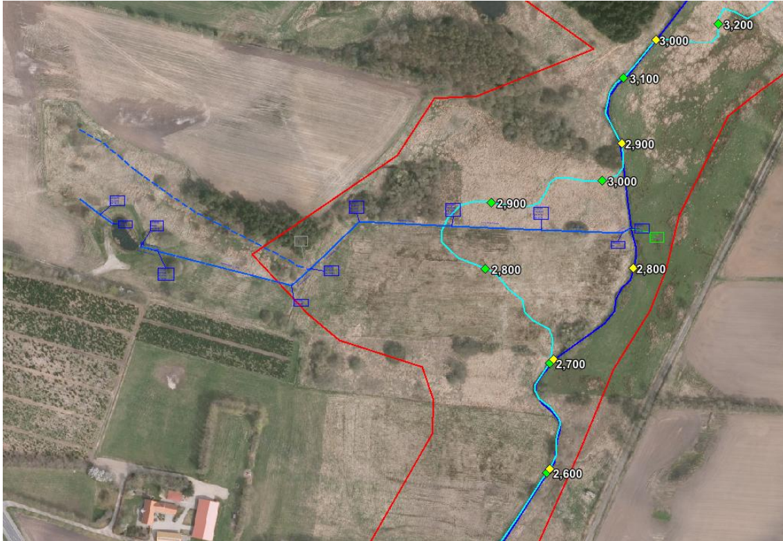
Figur 6 Regnvandsledning med udløb i Lemming Å
